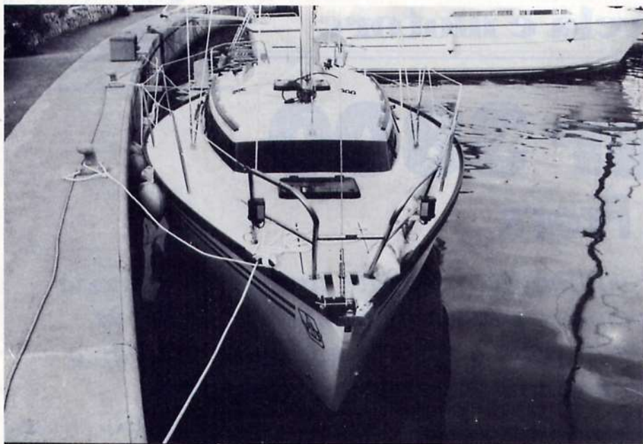
La prua del 3800 con il caratteristico pulpito per il passaggio in caso di ormeggio da prua. Davanti allo strallo si notano le due rotelle per la catena e la cima dell'ancora, dotate entrambe di chiusura per far sì che cima o catena non si sfilino. In basso, sullo scafo, le due bocchette di scarico dell'acqua del gavone di prua.
